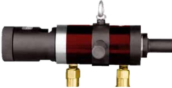
Bomba hidráulica semiautomática serie súper Jenny para extracción de tubos, permite que el operario extraiga continuamente los tubos a través de los cambiadores de calor, condensadores y calderas, sin el uso de los martillos, etc. La clave de nuestro sistema es la garra del Diámetro exterior que tirará del tubo mientras el operario maneja la máquina.
