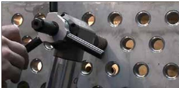
Ajustando tubos rápida y eficientemente. La máquina se bloquea con seguridad tanto al agujero roscado del tapón y al tubo.
