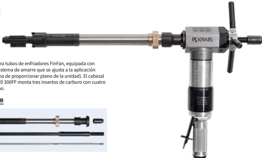
Máquina estándar para tubos de enfriadores FinFan, equipada con cabezal a medida y sistema de amarre que se ajusta a la aplicación solicitada (el cliente ha de proporcionar plano de la unidad). El cabezal de corte del la MiniMill 300FF monta tres insertos de carburo con cuatro filos de corte cada uno.
