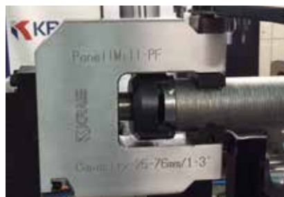
Aplicación retirada cladding en longitud 1".
