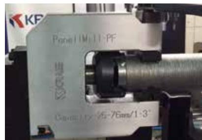
Usuwanie napawania na długości 25 mm
