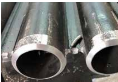
Usuwanie membran na głębokość 25 mm
