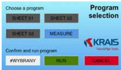
El robot es suministrado con el sistema de software KRAIS HMI dedicado exclusivamente a referenciar, expansionado de tubos, refrentado y soldadura tubo-placa. El sistema ha sido escrito para facilitar las operaciones del robot y esconder funciones que son innecesarias en el ambiente de trabajo o son demasiado avanzadas al principio del aprendizaje.
