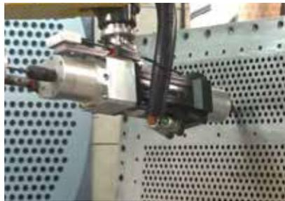
Mecanizado simultaneo de dos placas tubulares. Ambas fueron preparadas anteriormente, y ahora necesitan expansionado y refrentado de tubo. Después de una hora de ajuste, el trabajo se realiza de manera completa automáticamente.
